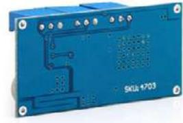
Pour une température supérieure à 40°C ou un courant supérieur à 2A mettre un système de ventilation forcée.
