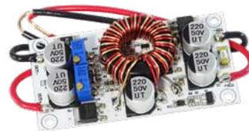
La tension de sortie se règle à l'aide d'un potentiomètre
