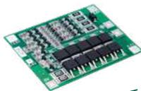
BMS intégré : La protection se fait par coupure de la batterie et la reconnexion est automatique
