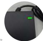
Un voyant rouge indiquant la charge de la batterie et passant au vert à la fin de la charge
