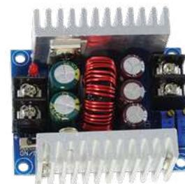
La tension de sortie se règle à l'aide d'un potentiomètre
